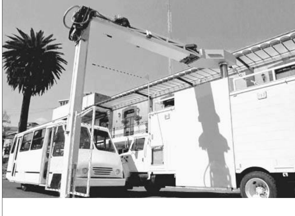
墨西哥缉毒机构2月5日首次向公众展示可移动的X射线边防检查车。该车折叠式曲臂可发出强大的X射线，将所查车辆的结构扫描入电脑进行分析。图为该车外形(右)，左为待查车辆。 新华社记者 部 南摄
